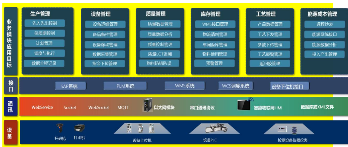
图 2 双星柬埔寨轮胎智能工厂整体架构图
