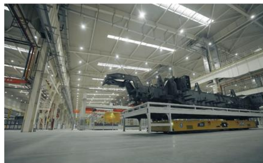
超大型结构件重载AGV智能物流转运
