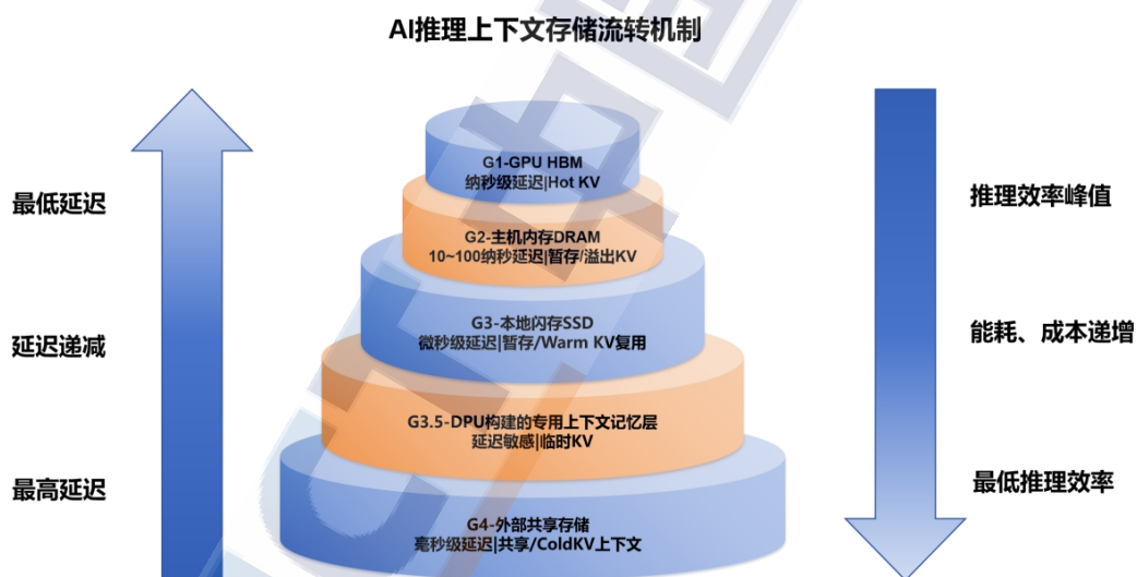
图 3 AI 推理上下文存储流转机制
